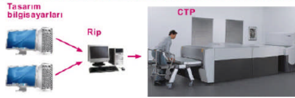
Şekil 2.1. CTP sistemi ile kalıp hazırlama aşamaları
