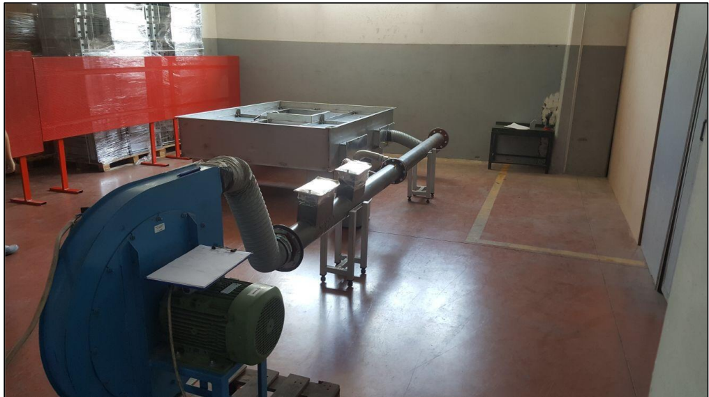
Şekil 10.9. Laminer Akış Ünitesi Sızdırmazlık Testi
