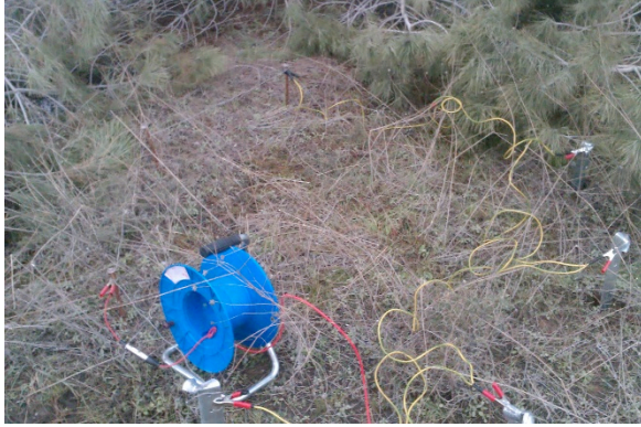
Şekil 1. Akım Kazıklarının Toprağa Çakılmış Hali
