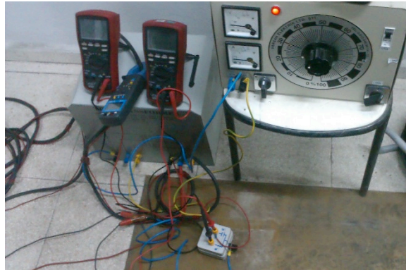
Şekil 4. Selvaz Metodu ile Toprak Empedans Devresi
