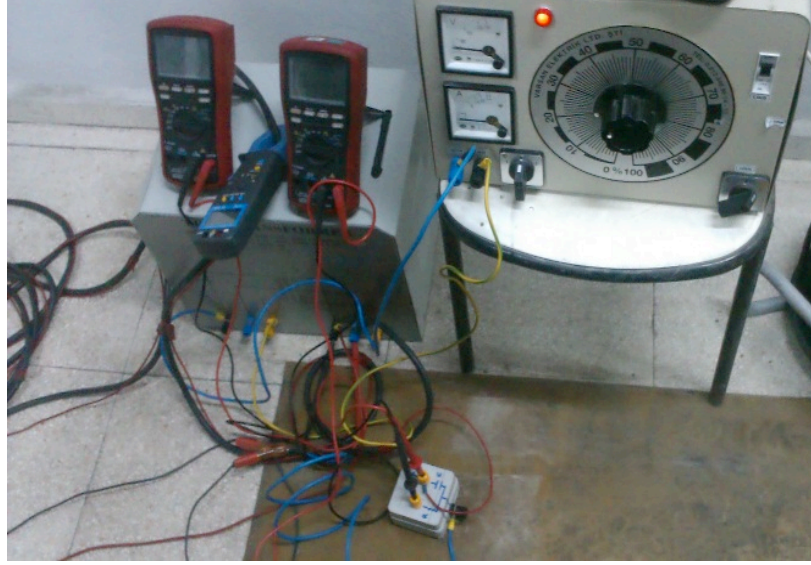
Şekil 4. Selvaz Metodu ile Kurulan Toprak Empedans Devresi
